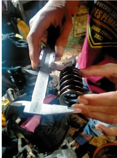
Gambar 3.15 Pemeriksaan Panjang Bebas Pegas Katup (Dokumentasi Pribadi)
