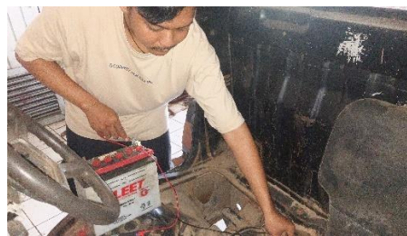
Gambar 3.6 Pemeriksaan Tegangan pengisian Alternator ke Baterai
