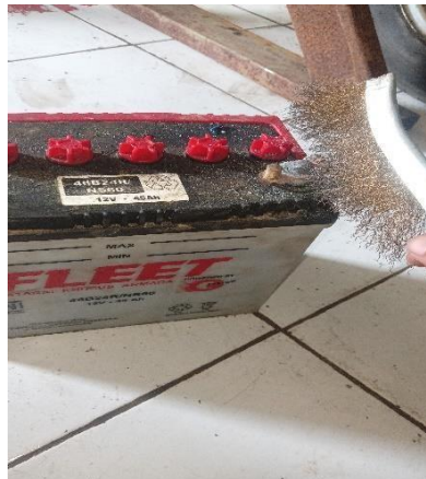
Gambar 3.1 pemeriksaan terminal baterai (sumber dokumentasi)
