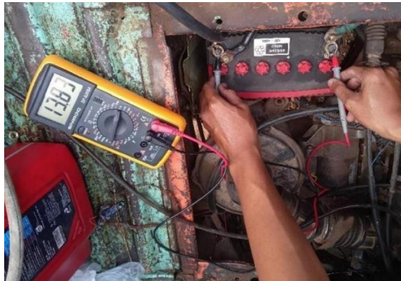
Gambar 3.5 tegangan baterai dengan beban saat mesin hidup
