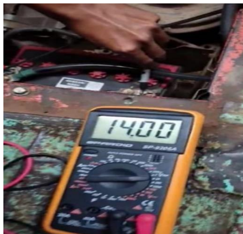
Gambar 3.4 pemeriksaan Tegangan Baterai saat mesin hidup
