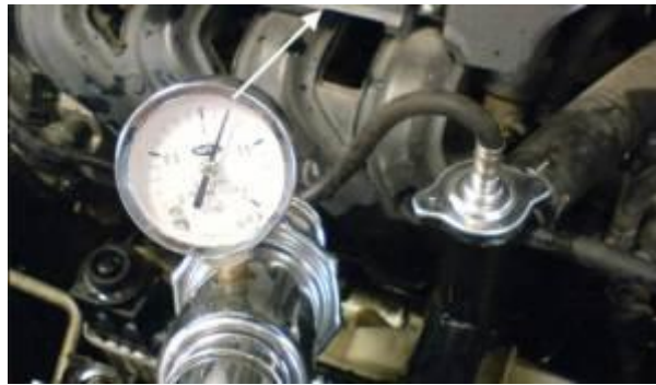
Gambar 3.10. Pemeriksaan Kebocoran Sistem Pendingin
