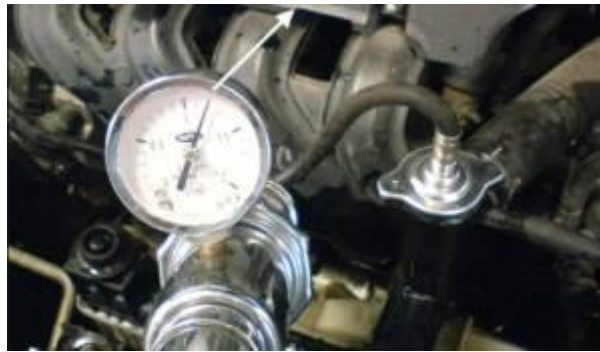
Gambar 3.10. Pemeriksaan Kebocoran Sistem Pendingin
