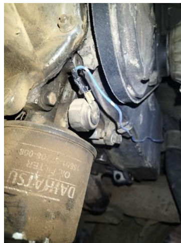
Gambar 11 pemeriksaan switch oli
