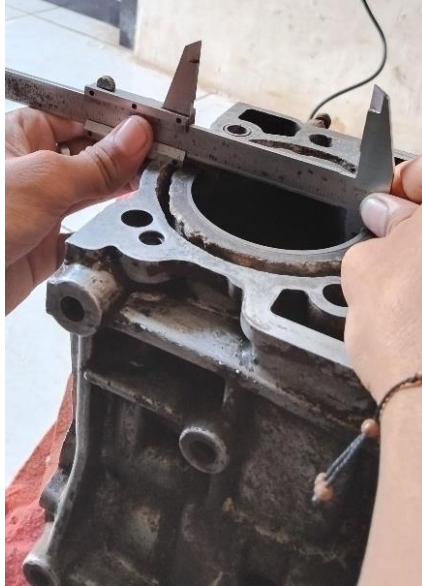
Gambar 11 Pengukuran Diameter Silinder Menggunakan Jangka Sorong
