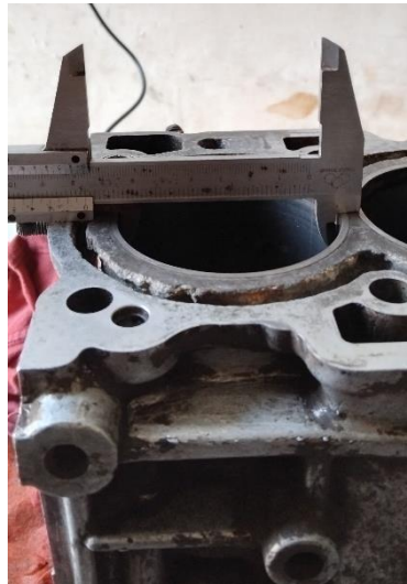
Gambar 12 Pembacaan Hasil Ukuran Jangka Sorong
