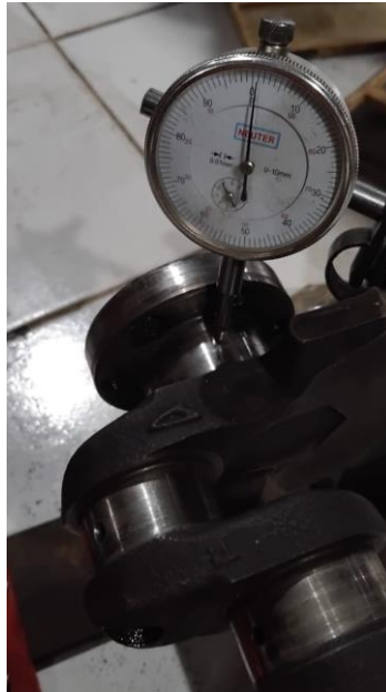
Gambar 15 Mengukur Keolengan Poros Engkol
