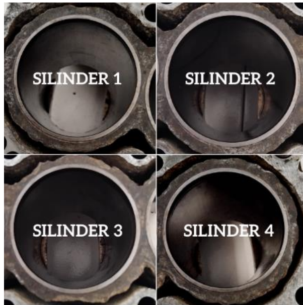
Gambar 8 Pemeriksaan Silinder Secara Visual
