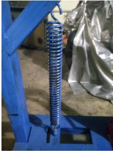
Gambar 3.14 Hasil uji tarik pegas
