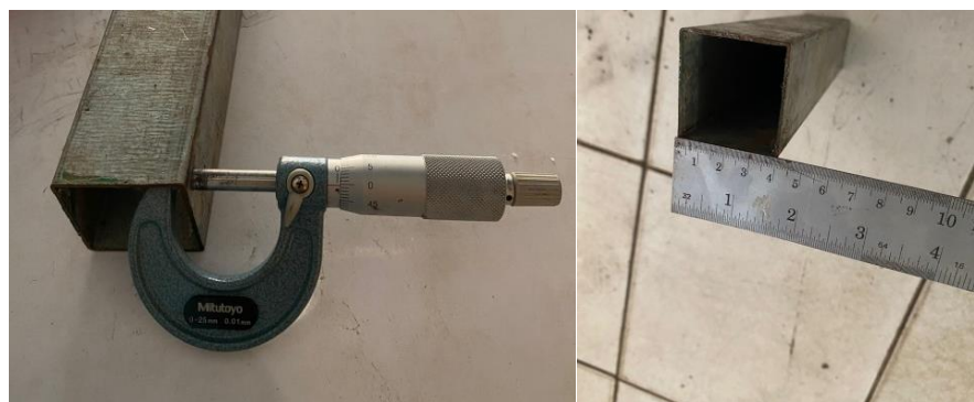
Gambar 1. Besi Hollow 40mm X 40MM Dengan Tebal 2mm
