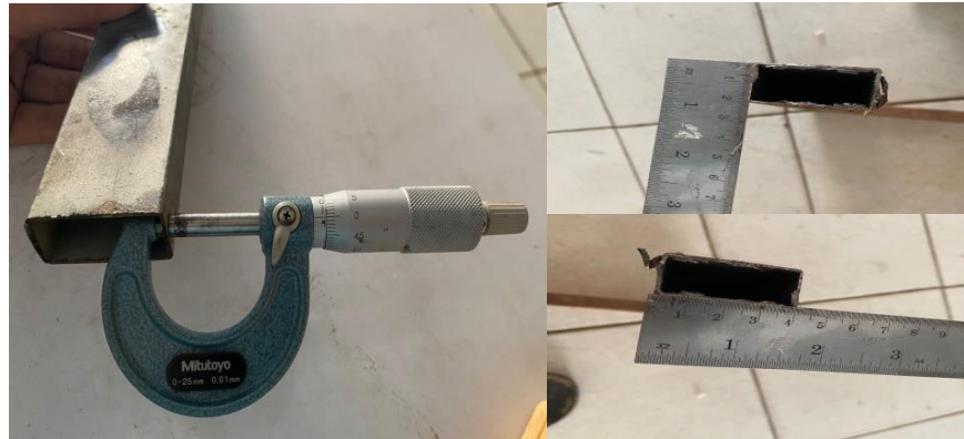
Gambar 2. Besi Hallow 40 mm X 20 mm Dengan Tebal 2mm
