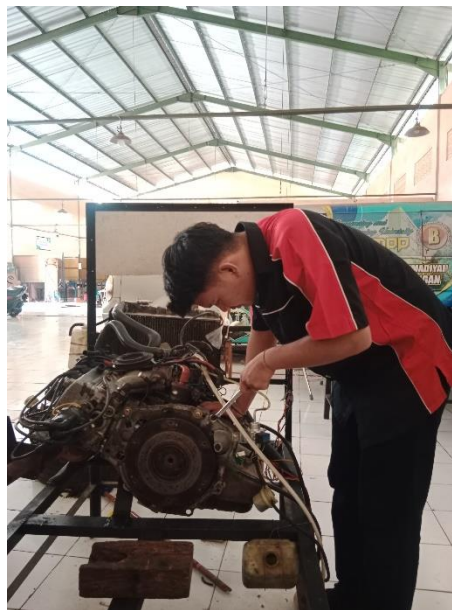
Gambar 2 Pelepasan Motor Starter
