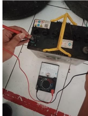
Gambar 15 pemeriksaan tegangan baterai
