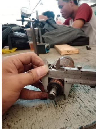
Gambar 7 pengukuran diameter komutator
