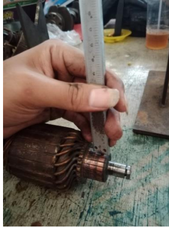
Gambar 8 pemeriksaan kedalaman komutator
