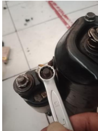
Gambar 3 pelepasan kabel penghubung teminal C dengan Field Coil
