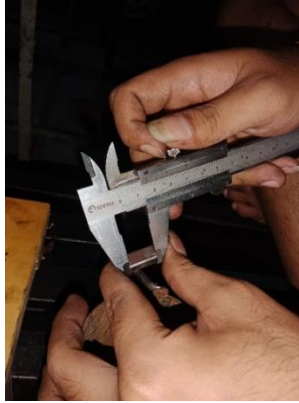
Gambar 11 pengukuran panjang sikat
