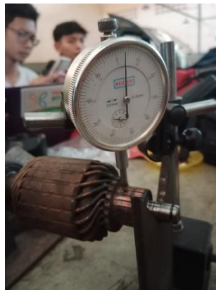
Gambar 6 pemeriksaan runout komutator
