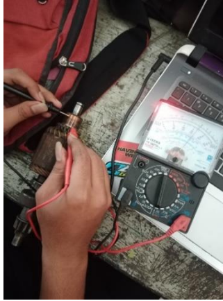
Gambar 5 pemeriksaan hubungan di komutator
