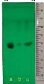
Gambar 1. Penampakan dan pengukuran bercak. (a) baku kafein, (b) sampel kopi robusta dan (c) sampel kopi arabica pada fase diam silika gel F254 pada detektor sinar UV 254 nm dengan fase gerak etil asetat: metanol : NH 4 OH pekat (85:10:5).
