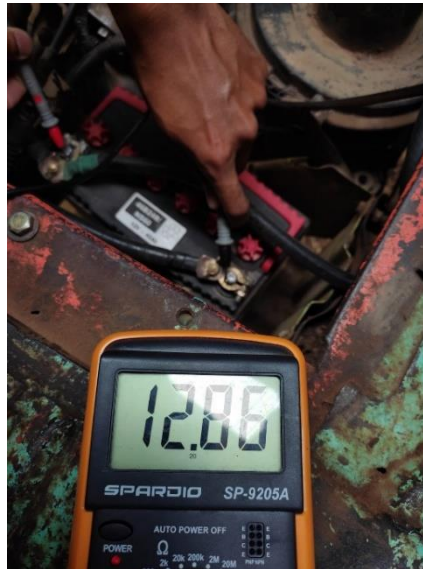
Gambar 3 Pemeriksaan Tegangan Baterai Mesin Mati
