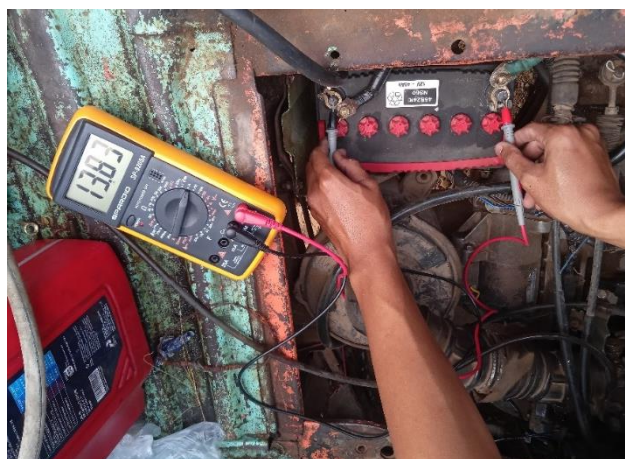
Gambar 5 Memeriksa Teganga Baterai Dengan Beban Saat Mesin Hidup
