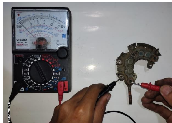
Gambar 19 Pemeriksaan Rectifier negative 1
