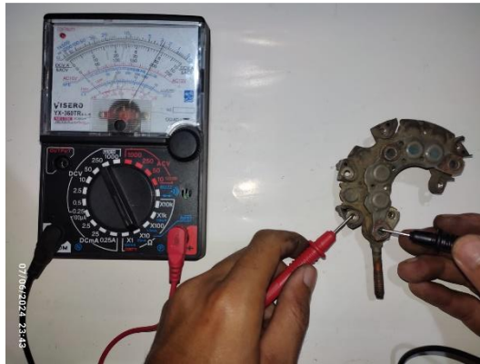
Gambar 20 Pemeriksaan Rectifier negatif 2
