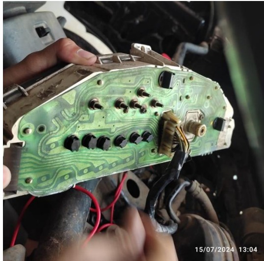
Gambar 21 Pemeriksaan Lampu Indikator (Sumber : Dokumentasi)
