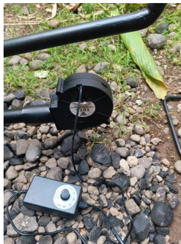
Gambar 3.11 Adaptor blower untuk mengatur api
