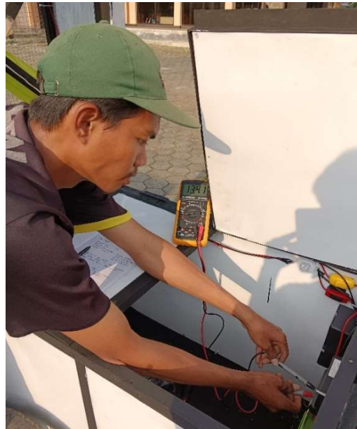
Gambar 4.1 Pengujian Tegangan Listrik Dari PLTS.
