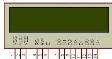
Gambar 2.9 Konfigurasi Pin LCD [11]
