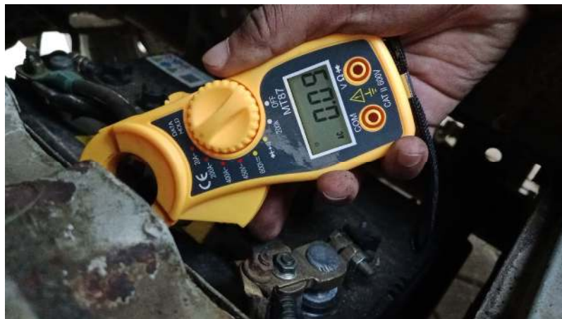
Gambar 4. 8 Pengukuran Pada Saat Mobil dalam Keadaan ON Saja
