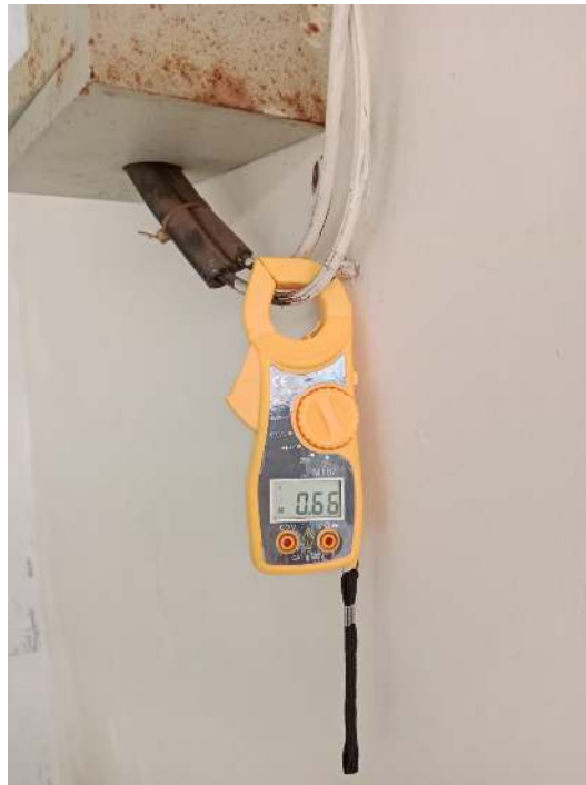
Gambar 4. 3 Kalibrasi Pada Ampere Meter Kedua
