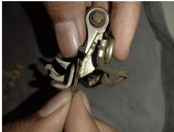
Gambar 4.6 Pembersihan pada platina
