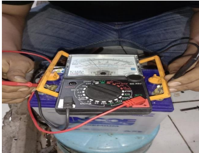
Gambar 4.2 Pemeriksaan arus pada Baterai
