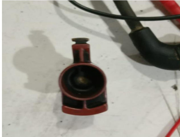
Gambar 4.4 Pemeriksaan pada rotor
