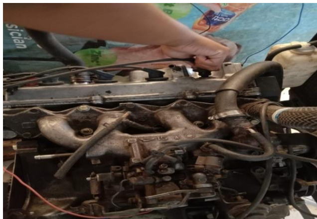
Gambar 4.3 Pelepasan kabel busi
