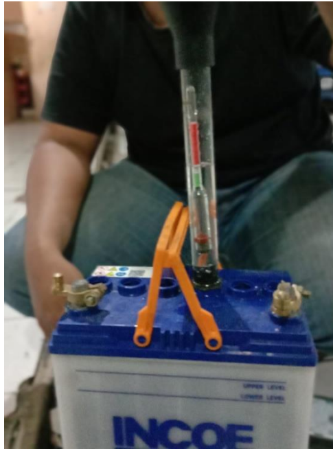
Gambar 4. 1 Pemeriksaan elektrolit baterai
