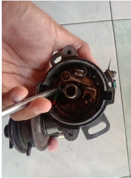
Gambar 4.5 Pelepasan platina
