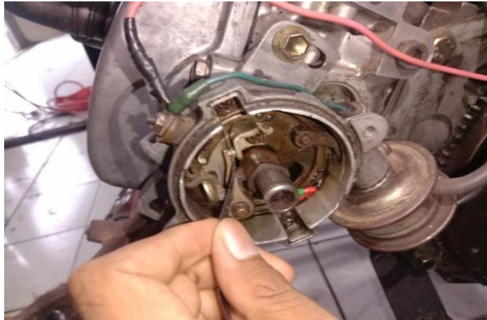
Gambar 4.13 Penyetelan celah platina
