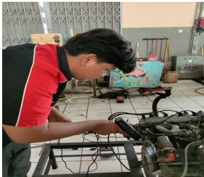
Gambar 4.19 Pemeriksaan menggunakan timing light
