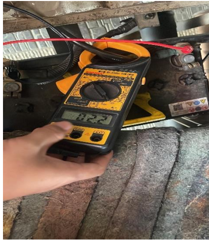
Gambar 3. 20 Pengukuran Arus Pada Panel Instrument
