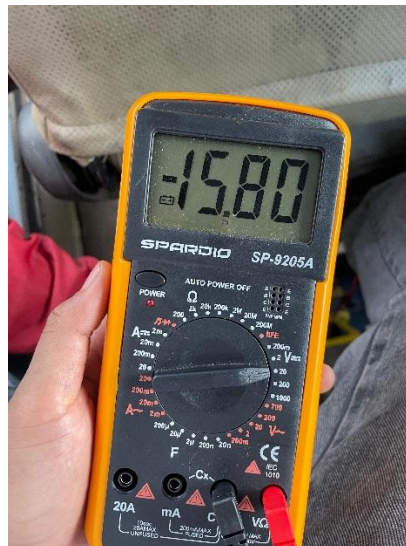
Gambar 3. 19 Pengukuran Tegangan Pada Panel Instrument
