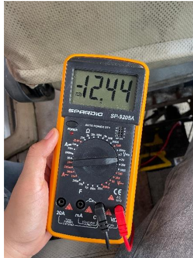
Gambar 3. 11 Pengukuran Tegangan Pada Lampu Sein
