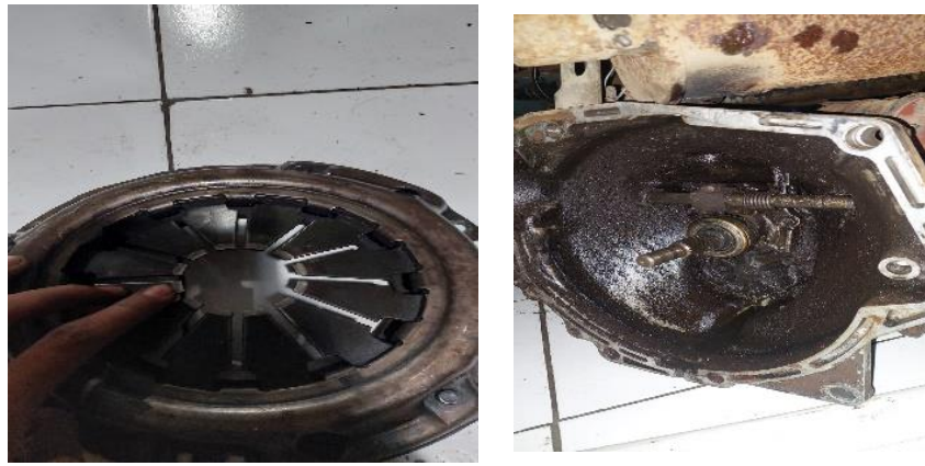
Gambar Pemeriksaan pada pegas penekan dan Tuas pembebas
