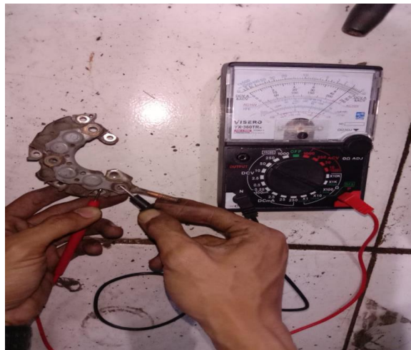
Gambar 3.10 pemeriksaan rectifier negatif 1
