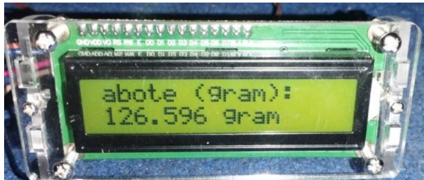
Gambar 4.5 Pengujian Sensor Load cell sebelum kalibrasi
