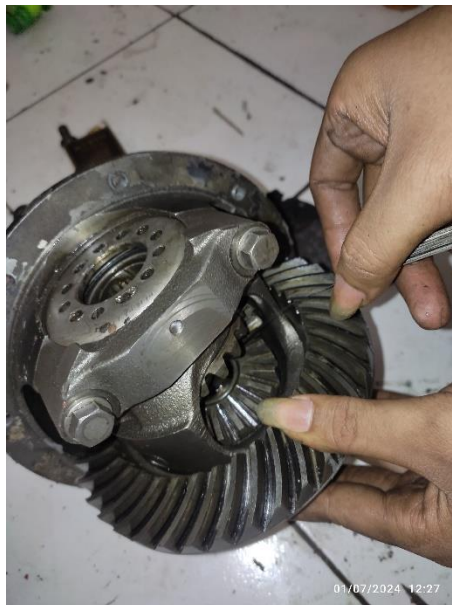
Gambar 7 Backlash roda gigi ring gear dengan drive pinion gear
