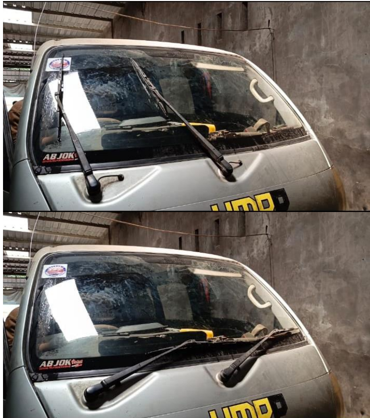
Gambar 3.18 Pengujian rangkaian wiper
