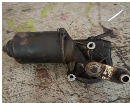
Gambar 3.4 Melepas motor wiper dari dudukannya
