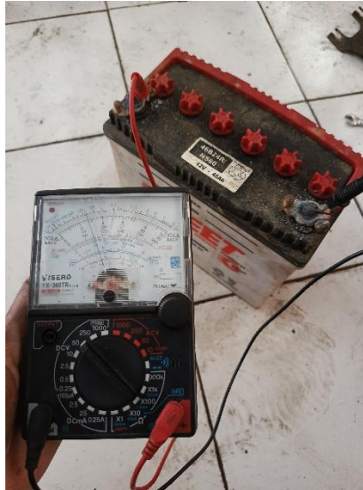
Gambar 3.3 Pemeriksaan tegangan baterai
