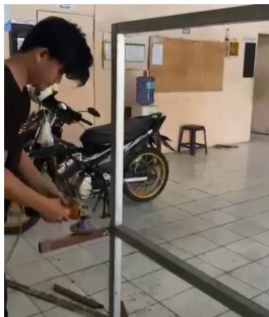
Gambar. menyikat rangka besi
