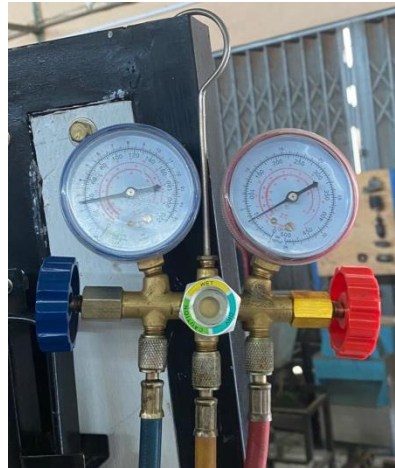
Gambar. jarum manifold pada saat tekanan tinggi
