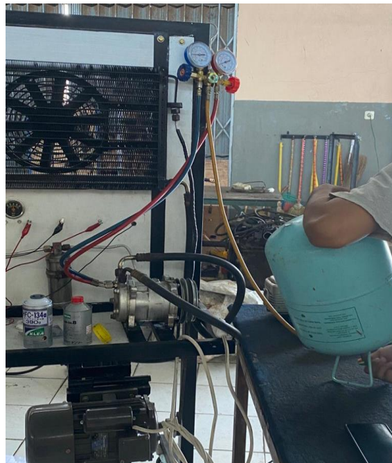
Gambar. pengisian refrigerant tekanan tinggi
