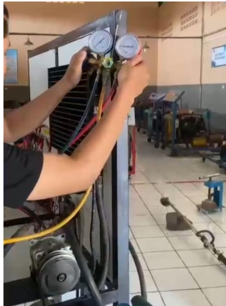
Gambar. jarum manifold pada saat tekanan rendah
