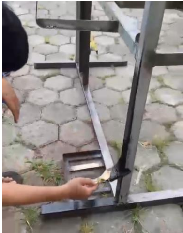
Gambar. mengecat rangka stand
