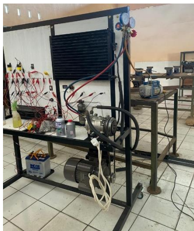
Gambar. Pempvakuman sistem AC
