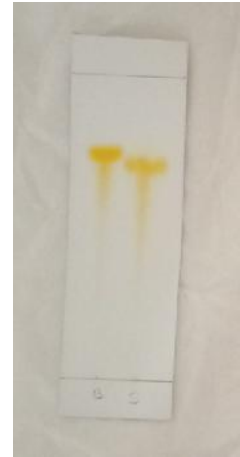
Gambar 3.1 Hasil kromatogram baku \beta -karoten dan ekstrak buah semangka kuning
