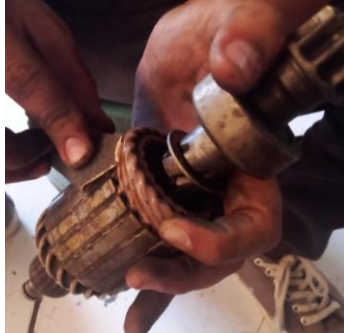
Gambar 3.5. pembersihan permukaan menggunakan amplas (sumber : dokumentasi pribadi )
