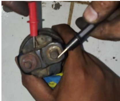
Gambar 3.13. Pemeriksaan pull in coil ( sumber : dokumentasi pribadi )
