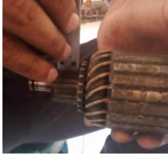
Gambar 3.8. pemeriksaan kedalaman komutator (sumber : dokumentasi Pribadi)
