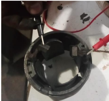
Gambar 3.9. pemeriksaan hubungan field coil ( sumber : dokumentasi pribadi )
