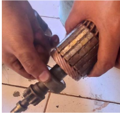
Gambar 3.18. Pemeriksaan cara kerja stater clutch ( sumber : dokumentasi pribadi )
