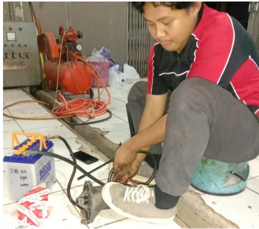
Gambar 3.20. Pengujian hold in coil ( sumber : dokumentasi pribadi )
