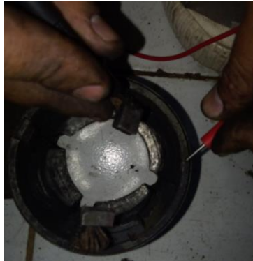
Gambar 3.10. pemeriksaan adanya massa pada field coil ( sumber : dokumentasi pribadi)
