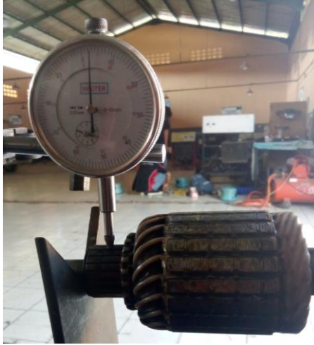
Gambar 3.6. pemeriksaan runout komutator
