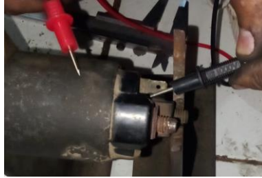
Gambar 3.14. pemeriksaan hold in Coil ( sumber : dokumentasi pribadi )
