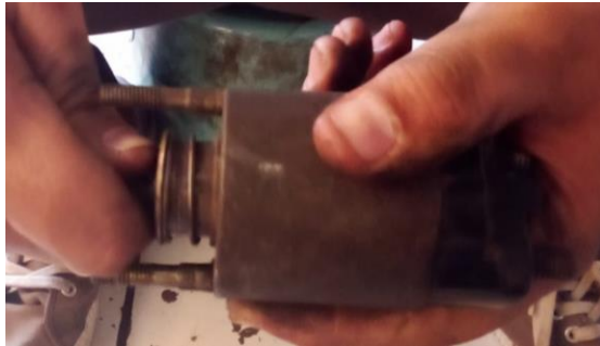
Gambar 3.12. Pemeriksaan kerja plunger ( sumber : dokumentasi pribadi )
