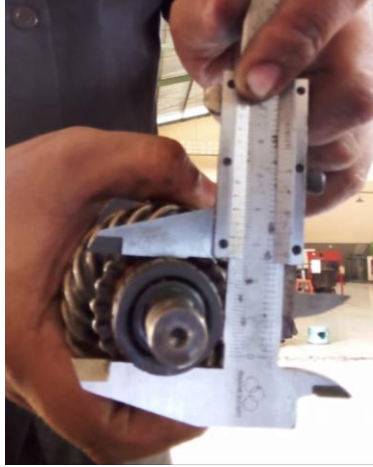
Gambar 3.7. pengukuran diameter komutator ( sumber : dokumentasi pribadi)
