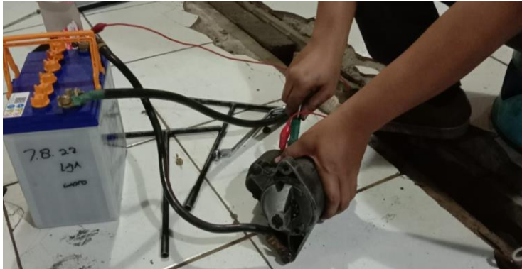
Gambar 3.19. pengujian pull in coil ( sumber : dokumentasi pribadi )
