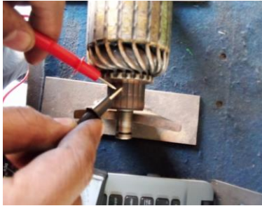
Gambar 3.4. pemeriksaan hubungan yang ada di komutator ( sumber : dokumentasi pribadi )
